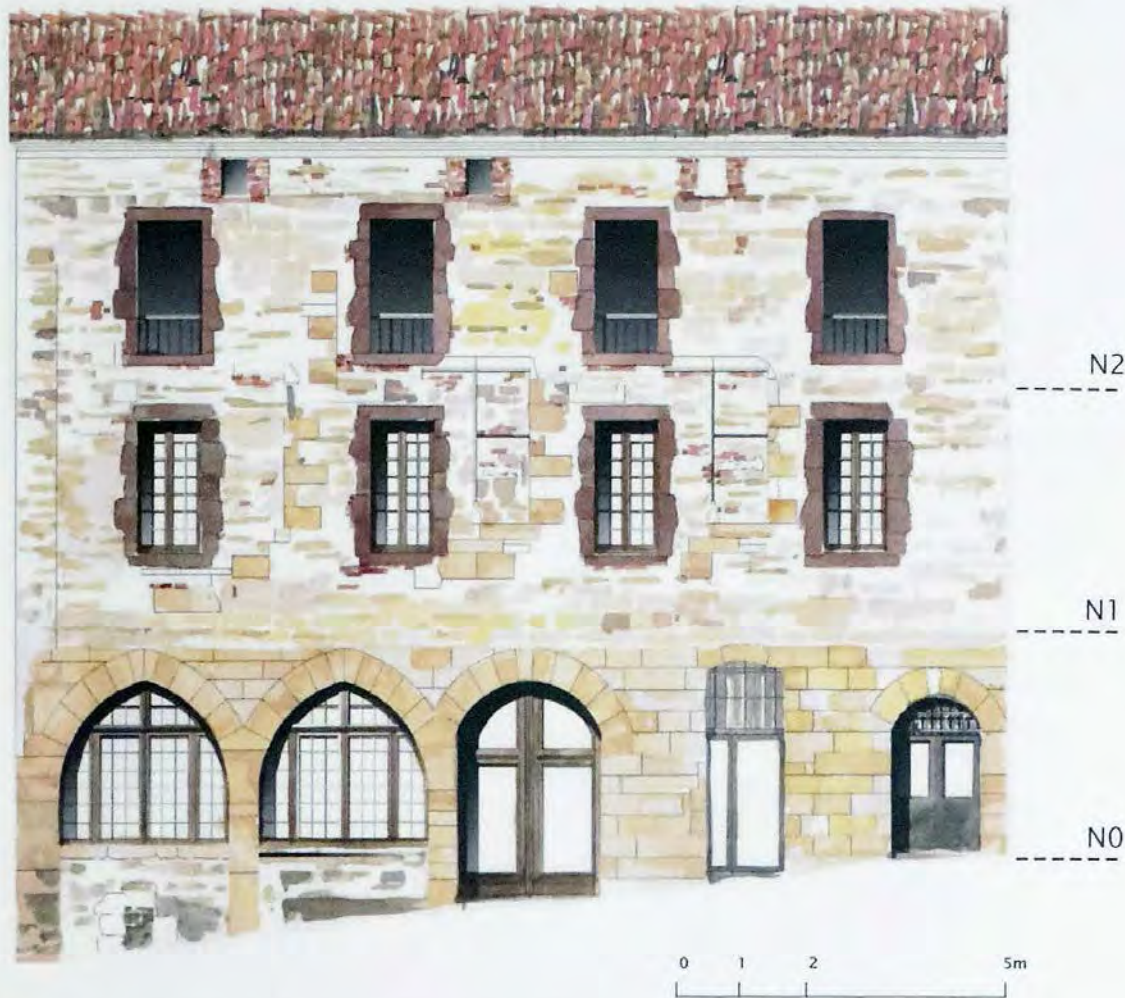
Façade sur la rue Saint-Michel : lecture des traces archéologiques et repérage des matériaux de la façade à l'extérieur et l'intérieur. Confrontation des relevés avec les autres façades sur cour et hypothèse de chronologie relative en conclusion.
