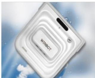
Ce robot convient à différents types de fenêtre avec ou sans cadre. Il faut placer le robot sur la fenêtre, appuyer sur démarrer et le robot, muni d'une lingette imbibée de détergent, se débrouille tout seul pour nettoyer celle-ci. Le robot est équipé de différentes solutions techniques, permettant de le rendre automatique.
