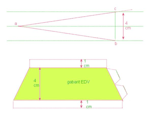
Pour déterminer l'emplacement du point c', <u>placer le gabarit au point b</u>, comme indiqué sur le croquis ci dessous.
