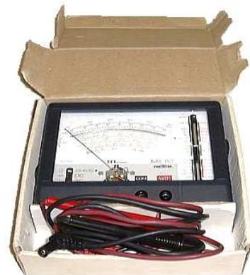
Au delà de l'aspect mécanique, la métrologie s'applique également aux mesures électroniques, avec ici un multimètre analogique de 1988 Métrix MX112 de ITT Instruments.
