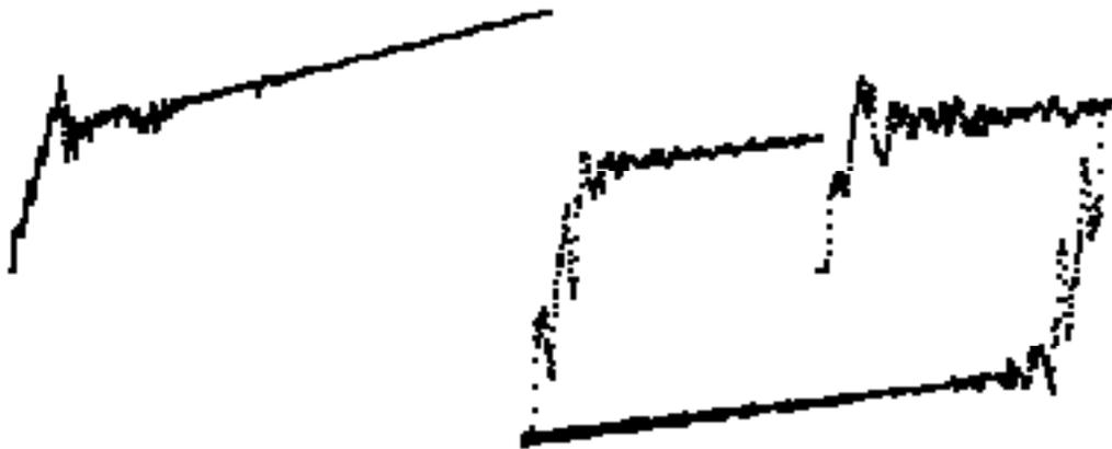
FIGURE 7. Courbe de traction (à gauche) et cycle complet de traction-compression (à droite) sur un matériau avec limite élastique supérieure et érouissage. A droite, des oscillations apparaissent sur la courbe; elles proviennent de la propagation d'ondes dans l'éprouvette. En effet, pour minimiser la durée du calcul l'essai numérique est effectué à grande vitesse (10 m/s). Le démarrage de l'essai provoque un choc et donc une propagation d'ondes.
